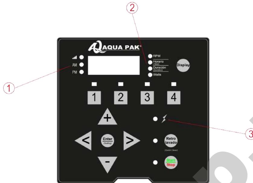
1. Tubo digital del panel de control: Permite visualizar la velocidad actual, la hora, la duración, el consumo de energía, el aviso de conexión Bluetooth y otras funciones.
