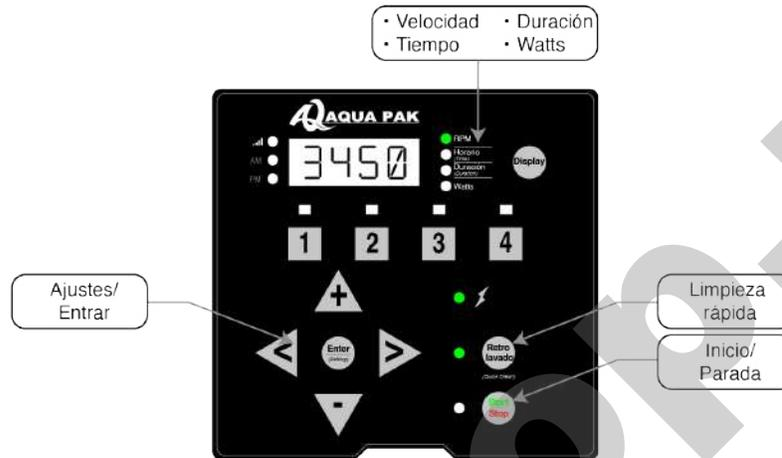
3. Usa los botones "+" y "-" para ajustar la velocidad de Limpieza Rápida en RPM. Usa "<" y ">" para mover el cursor.
